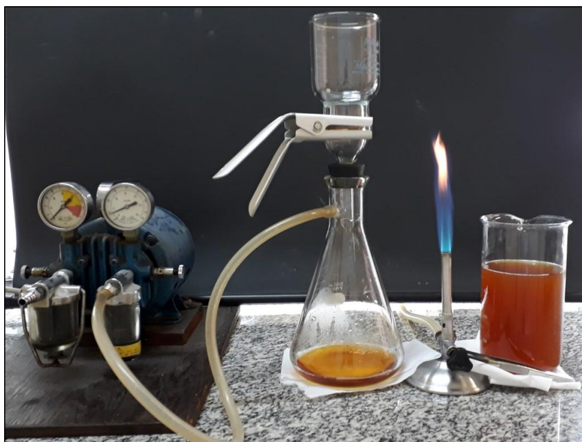
Figura 4. Filtração do chá após o tempo de incubação (10, 20 e 30 dias) em Sistema MILLIPORE® com membrana Millipore de 0,2 \mu\text{m} .
