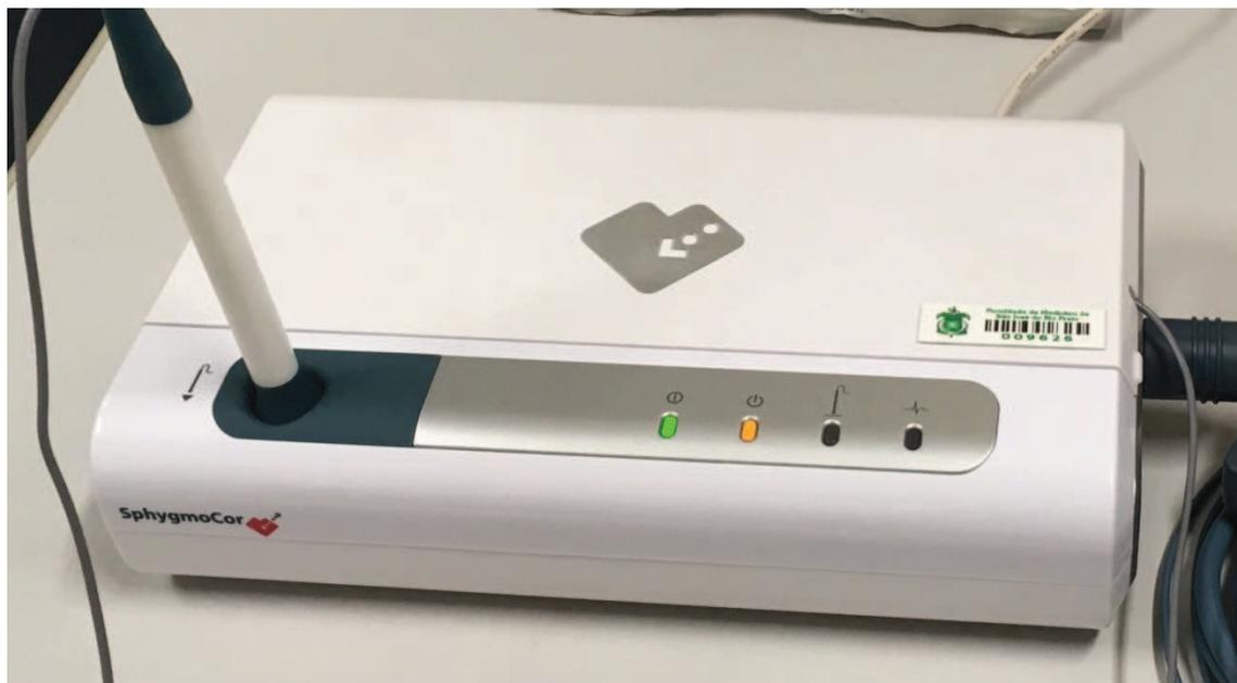
**Figura 3:** Dispositivo *SphygmoCor*<sup>®</sup> utilizado para avaliação não-invasiva da hemodinâmica central.
