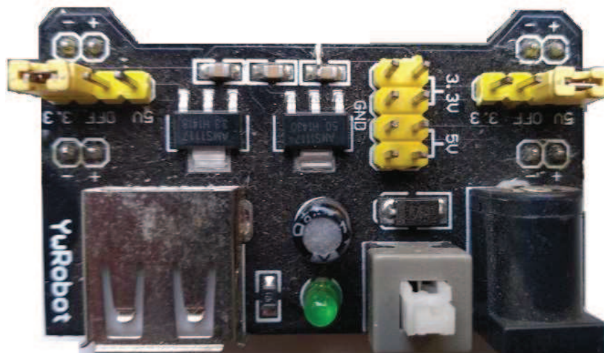
Figura 20 - Módulo fonte de alimentação.
