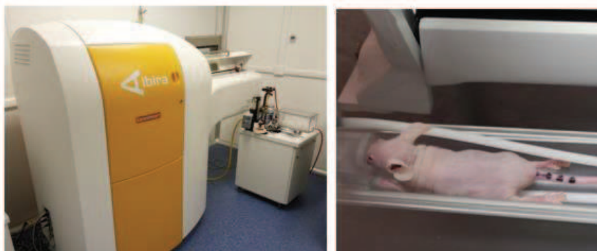
Figura 2: Equipamento de micro-PET/CT do IPEN e detalhe do local onde o camundongo é posicionado e mantido sob anestesia inalatória para aquisição das imagens.
