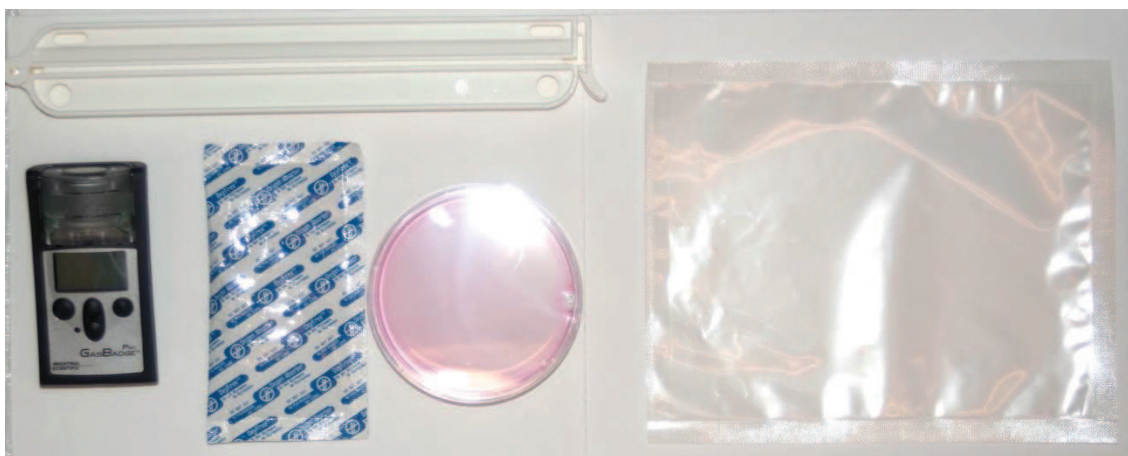
Figura 1: Itens da Câmara de hipóxia. 1. Clipe que impede entrada e saída de gases. 2. Sensor de O_2 . 3. Absorvente de O_2 . 4. Placa de cultivo. 5. Recipiente de plástico.
