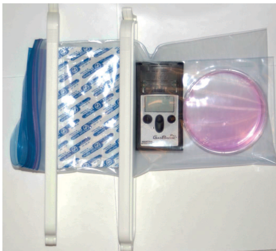
Figura 2C: Câmara de hipóxia com o clipe central. Deste modo é possível regular a quantidade de O_2 em que as células serão cultivadas. Alcançando a concentração de O_2 desejada, veda-se o clipe central e segue-se observando a concentração pelo sensor.
