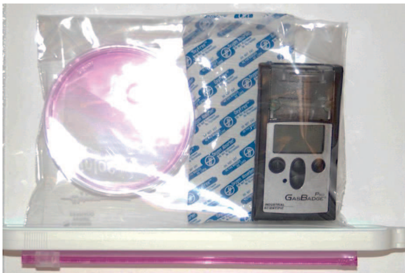
Figura 2B: Câmara de hipóxia. Câmara em funcionamento. Nota-se que o clipe é utilizado neste caso para garantir a vedação do plástico.
