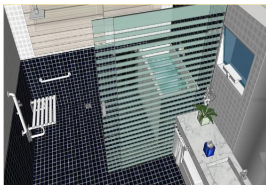
Figura 17. Banco fixado à parede do banheiro.
